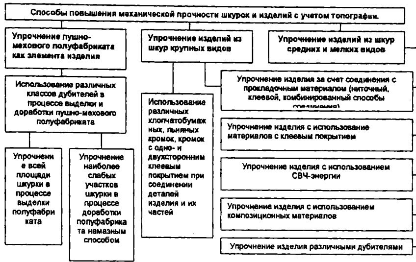
Рис. 1. Классификация способов повышения механической прочности изделий из натурального меха.
